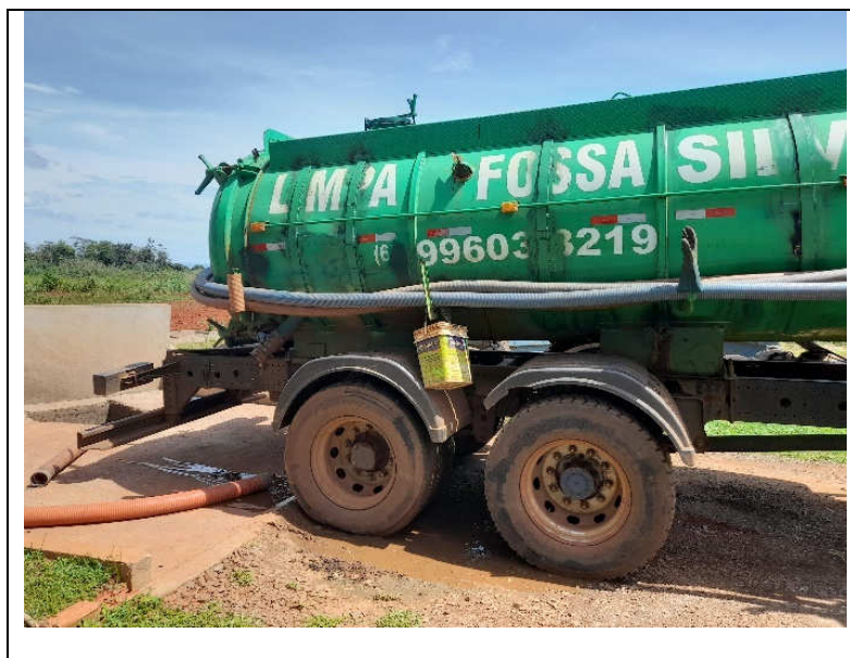
Foto 4.7- Descarga de limpa fossa na chegada do esgoto.
