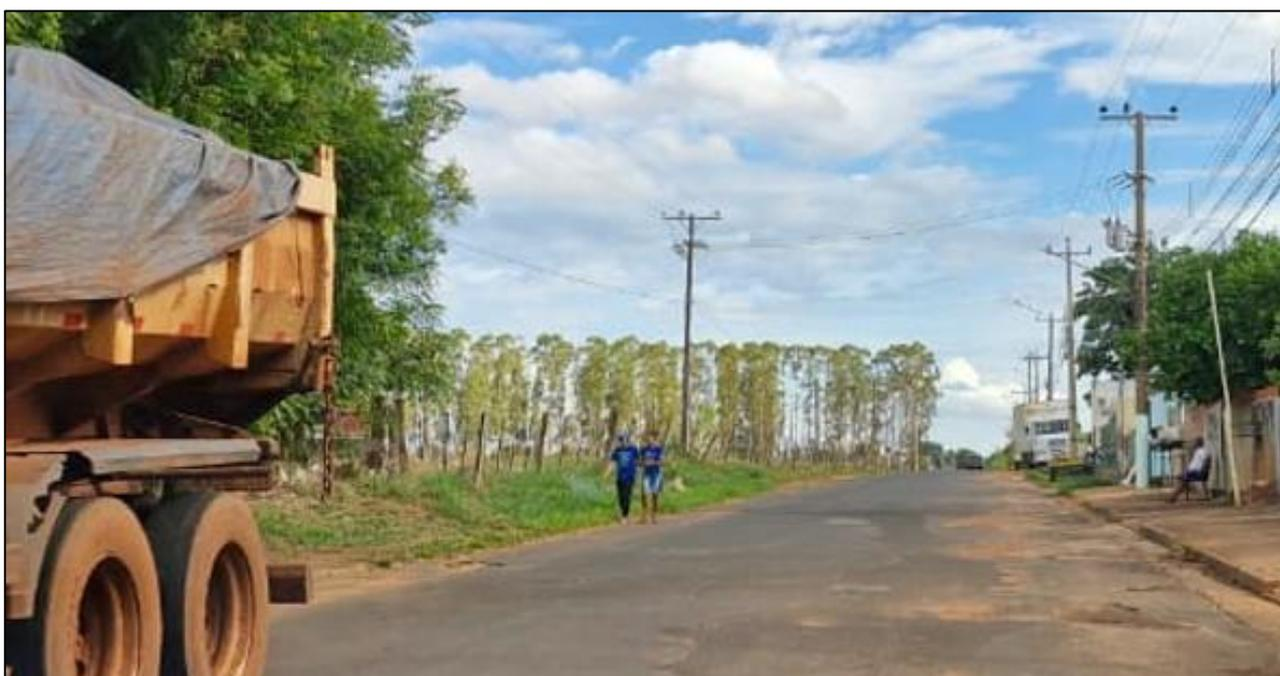
**Imagem 9.1.12:** Ausência de calçada em via com circulação de veículos pesados, fator de risco para pedestres.
