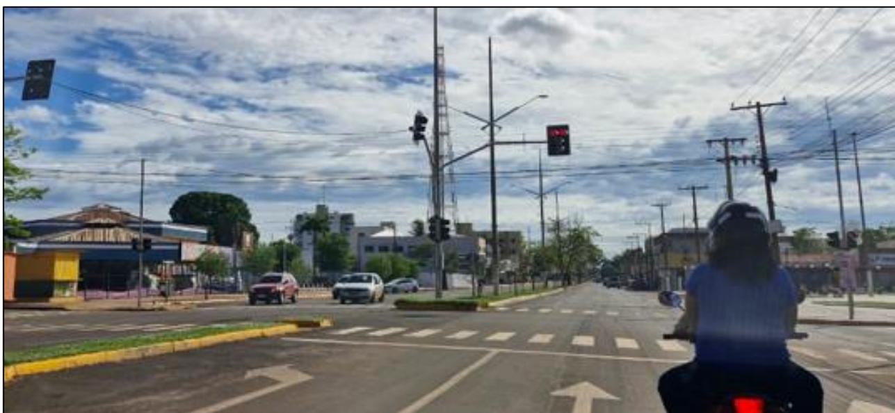
**Imagem 9.2.16:** Ausência de grupo focal repetidor, em desacordo com o Manual Brasileiro de Sinalização Semafórica.
