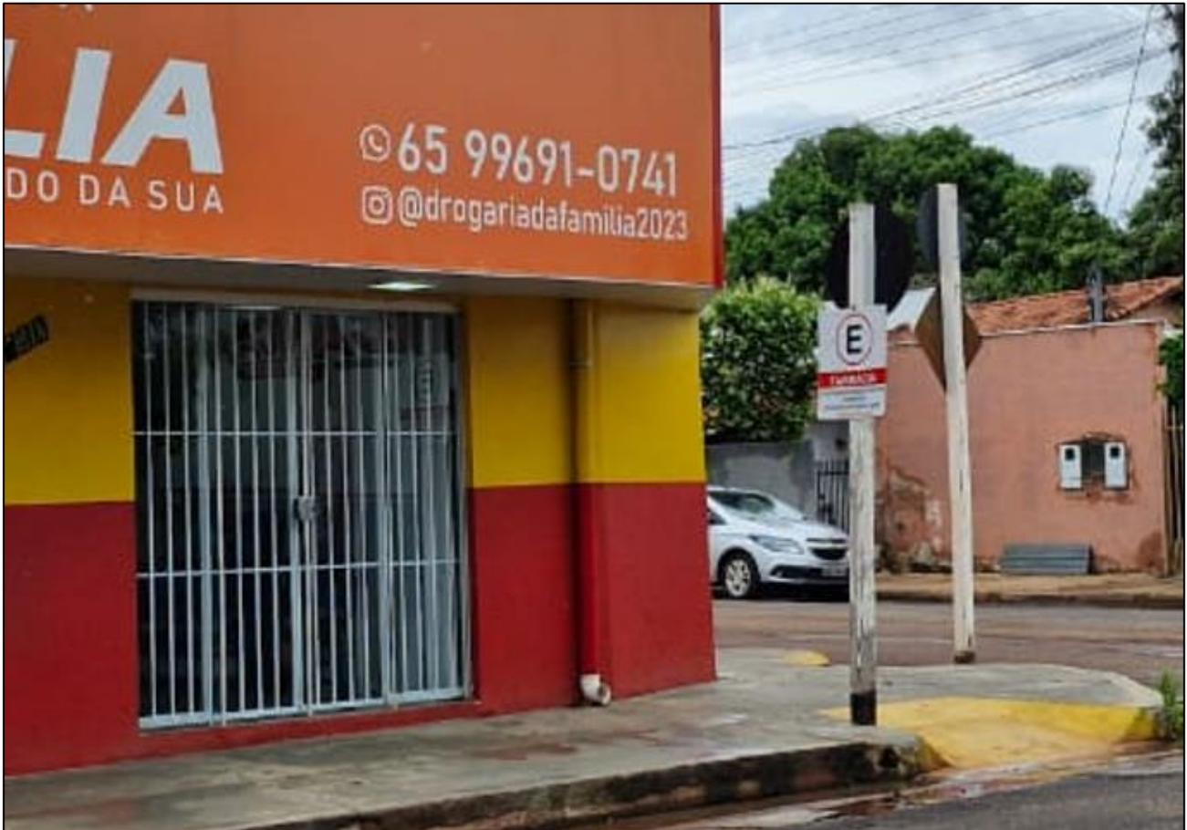
**Imagem 9.2.11:** Placa (R-6b com informações complementares) em desconformidade com o CONTRAN, sobre regulamentação de estacionamento.
